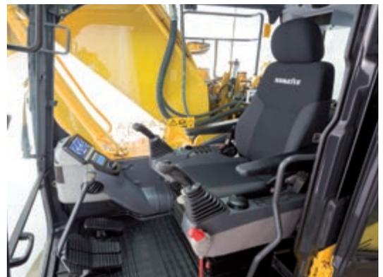
Le poste de commande à suspension pneumatique intégrale assure un confort maximum à l'opérateur.
